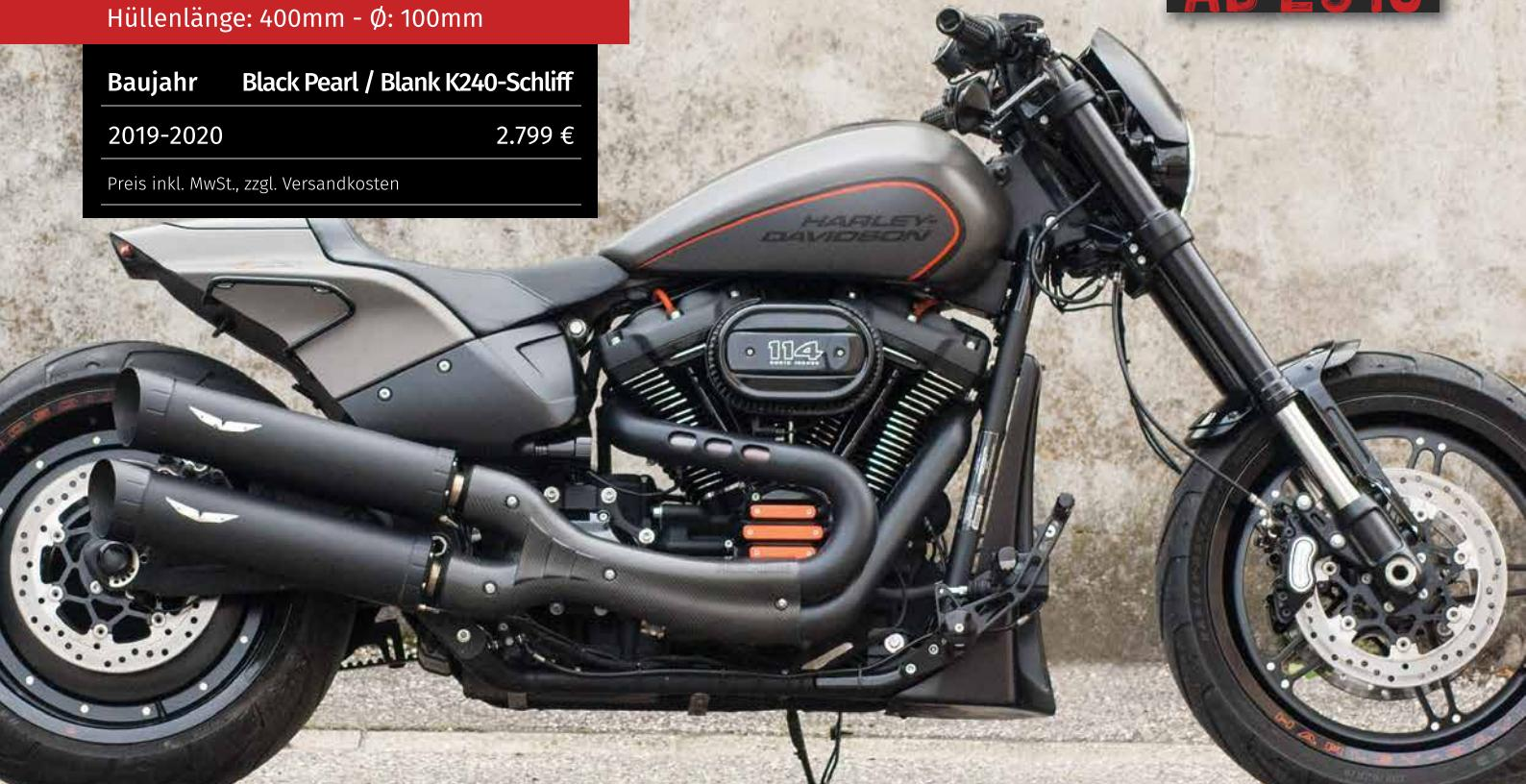
**Auspuffanlage mit X-Pipe-Krümmerführung und hitzefester Blende mit echtem Carbonfinish.**
