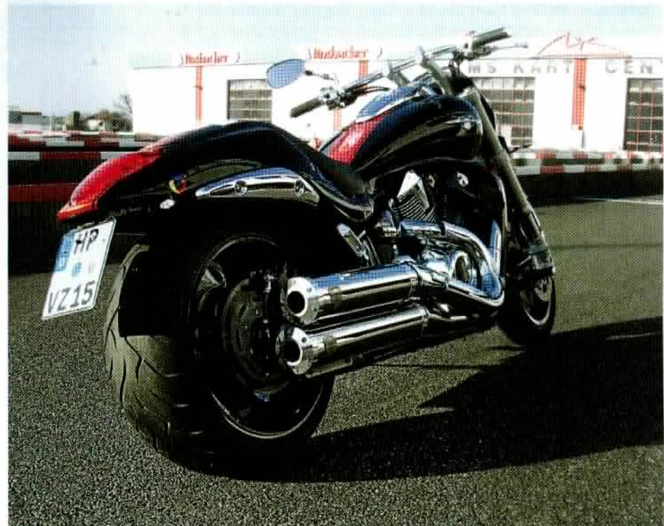
klappen, Zündkerzen und Nockenwellen arbeiten in dem 54-Grad-V2 mit den größten Kolben im Serienbau; sie messen 112 mm und ermöglichen satte 160 Newtonmeter - Dampf aus dem unteren Drehzahlbereich ist somit garantiert.
