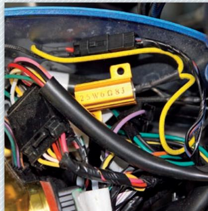
Unter der Abdeckung des Frontscheinwerfer findet sich genügend Platz, um die Widerstände für die LED-Blinker zu verstauen.
