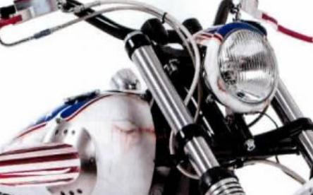
Die kurze Eigenbau-Gabel steht eng am Gooseneck, was entscheidend zur sportlichen Linie des Umbaus beiträgt
