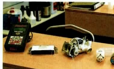
(Oben) Die Komponenten der ersten Harley-Einspritzanlage: Scanalyzer, Steuer- und Ansaugmodul, Kraftstoffpumpe und Kraftstofffilter (Unten) Das erste Messgerät für das originale Harley-ECM hatte das Format eines Taschenrechners und hieß „Scanalyzer“. Das gab's natürlich nur für autorisierte Dealer
