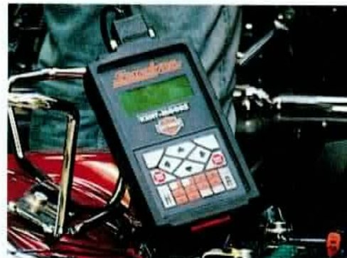
(Oben) Die Komponenten der ersten Harley-Einspritzanlage: Scanalyzer, Steuer- und Ansaugmodul, Kraftstoffpumpe und Kraftstofffilter (Unten) Das erste Messgerät für das originale Harley-ECM hatte das Format eines Taschenrechners und hieß „Scanalyzer“. Das gab's natürlich nur für autorisierte Dealer
